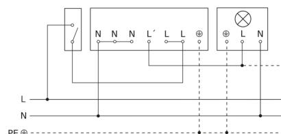
Raccordement par commutateur séquentiel pour la commande manuelle ou automatique
